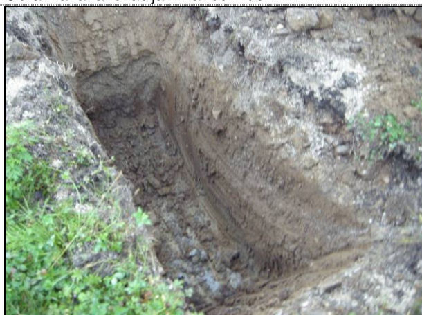
Razkop R-1: zgoraj ca 25 cm tampona in kamnite grede, spodaj do globine 1,7 m rjava meljasta glina, na dnu meži voda
