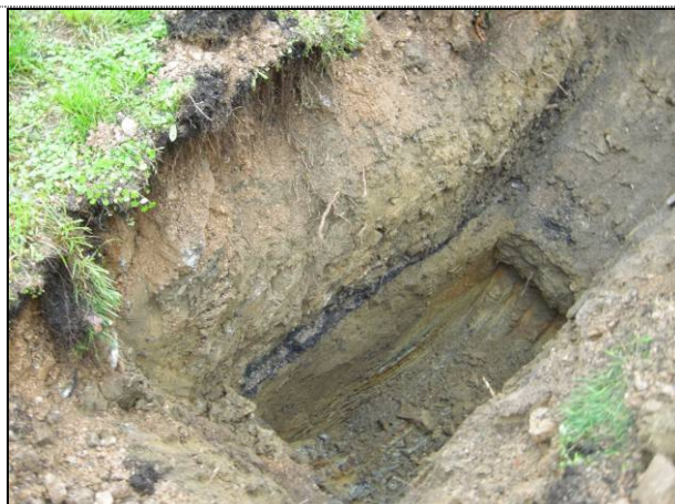
Razkop R-3: zgoraj ca 60 cm nasipa (meljast grušč), do globine 3,1 m rjava meljasta glina (med 1,6 -1,9 m temnorjav – črn rahel melj), spodaj fliš - laporovec
